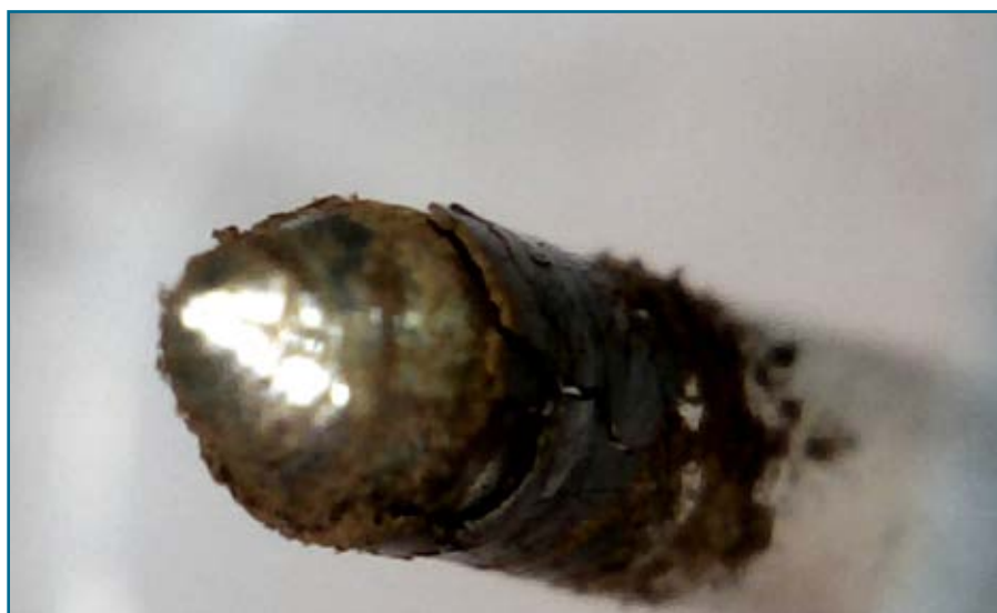
Fot. 1. Zdjęcie korozji na osi liczydła wodomierza (średnica 0,5mm)
