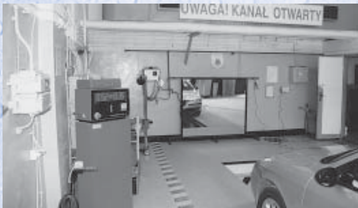
Przyrząd do badania siły hamowania „HAMULCOMIERZ BHE-5C”
