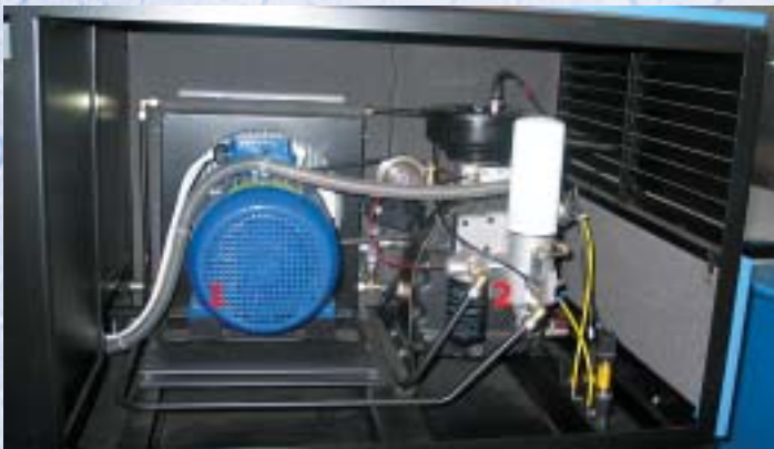
Wnętrze agregatu: 1 - silnik, 2 - elektryczny zespół śrubowy
