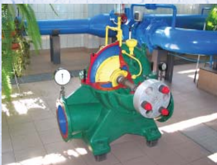
„Przekrojona” pompa starego typu
