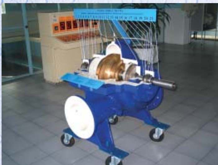
Pompa „Omega” w przekroju
